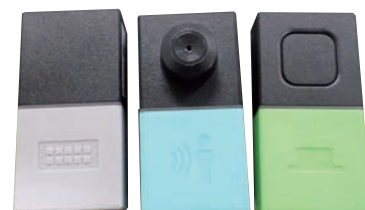
センサーやスイッチなどの機能を持ったMESHブロック
